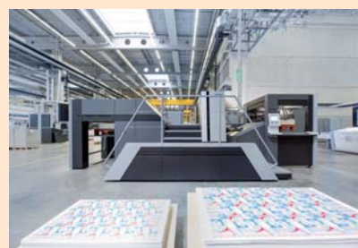
HEIDELBERG XL 106-D, una troqueladora rotativa especializada en in-mold.
