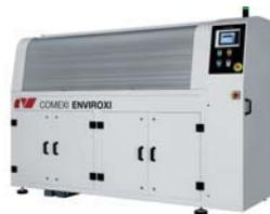
Comexi ENVIROXI LCR es una herramienta de trabajo para lograr una limpieza de cilindros anilox sobre cualquier tipo de tintas, adhesivos o siliconas, incluso sobre altas líneas difíciles de limpiar. Además, el sistema láser evita el daño de la superficie del material lavado.
