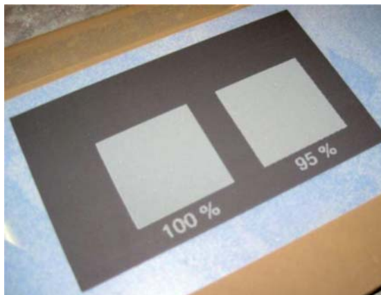
Imagem de impressão da pasta de ânodo sobre a capa de grafite, mediante serigrafia.
