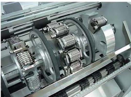
*Registro de impresión mecánico, que evita los problemas de fallos producidos por otros sistemas con sensores y embragues.*
